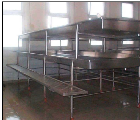
Fig. 4 – vasche doppie per carenza di spazio (situazione da evitare) con pedana antiscivolo
