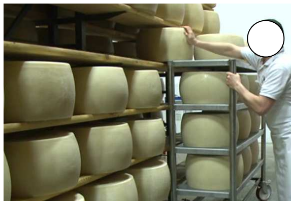
Fig. 23 - spinta frontale in isolivello da cestello a scalone
