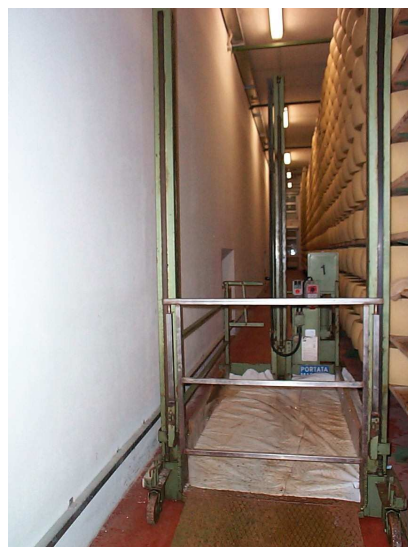
Figg. 21 e 22 – esempio di corsia adeguata e di sistemazione corretta del cestello sul piano elevabile (con spinta frontale → fig. 23)
