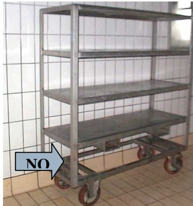
Fig. 18 – cestello metallico da camera calda (con ripiano più basso non utilizzato)
