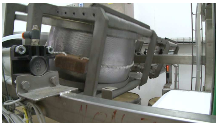
Fig. 13 - macchina per rotazione delle forme
