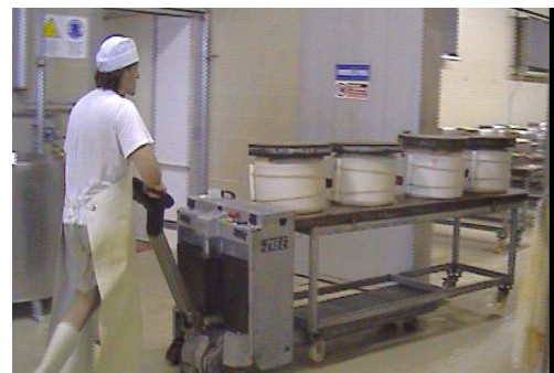
Fig. 11 – esempio di carrello elettrico per trasporto spersoli
